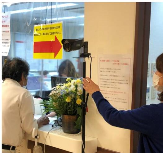
受付前にカメラを設置し、外来者の動線を限定します。一時停止した場合、検温精度が上がりますので、靴型の「止まれマーク」を設置します。
